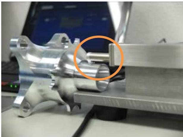
図 5 ハブの粗さ試験
